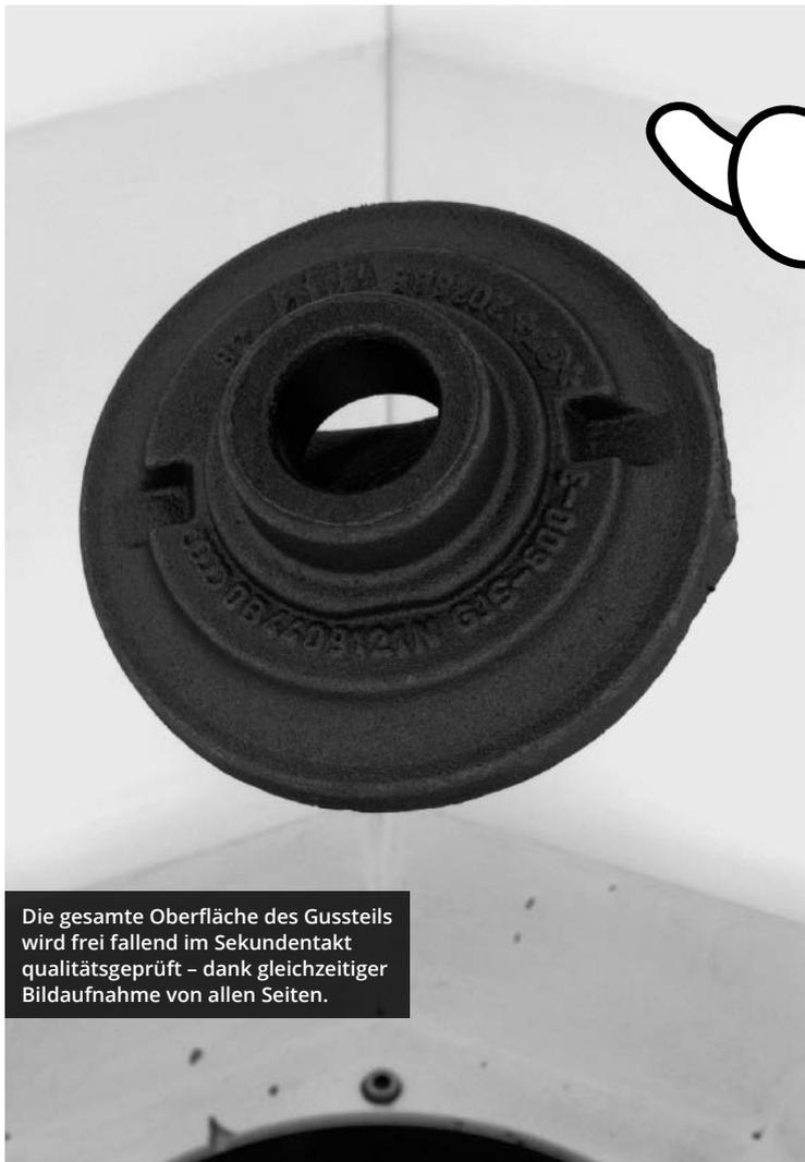
Die gesamte Oberfläche des Gussteils wird frei fallend im Sekundentakt qualitätsgeprüft – dank gleichzeitiger Bildaufnahme von allen Seiten.
