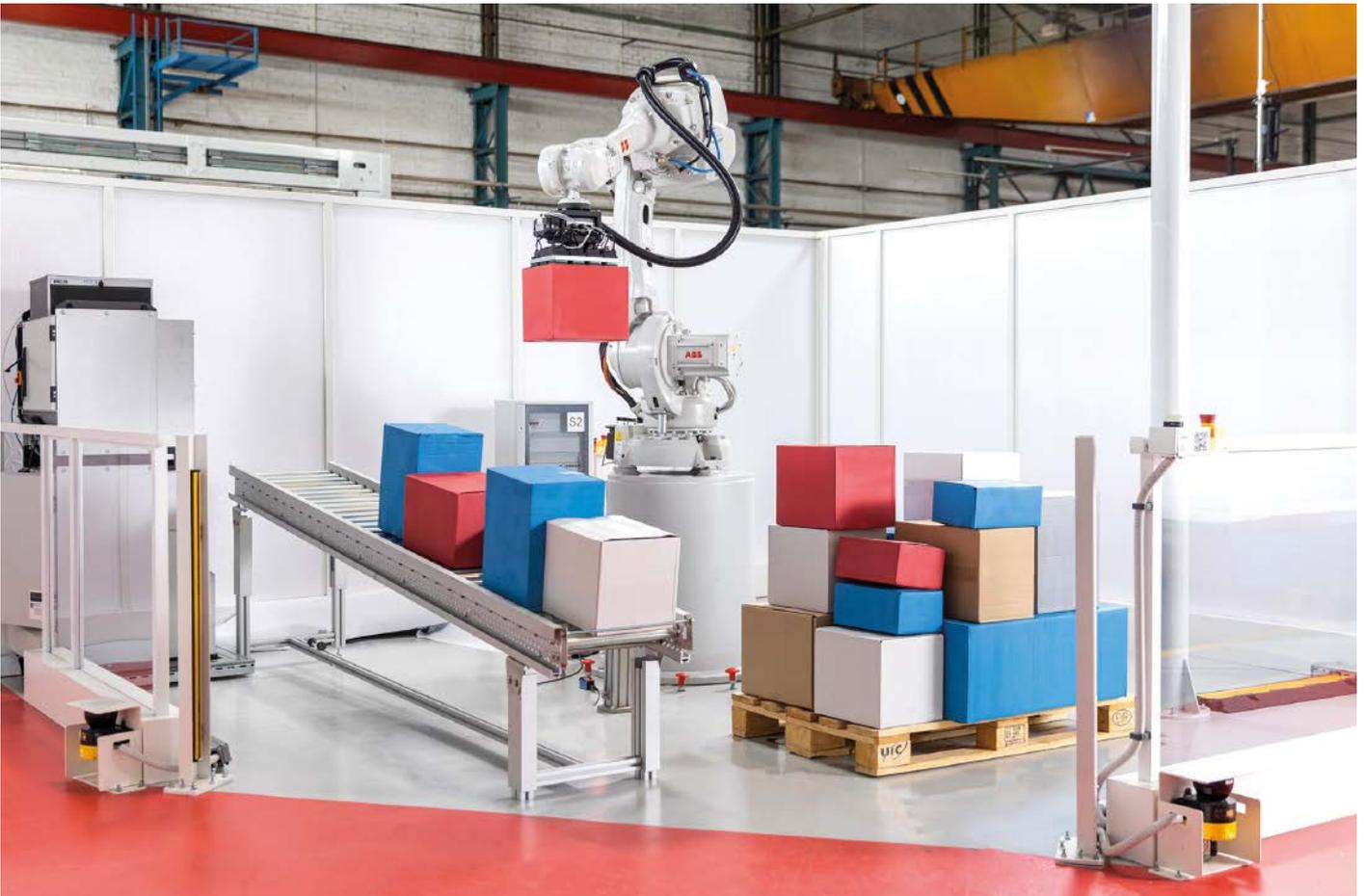
Mit dem ABB Robotic Depalletizer lassen sich viele Depalettier-Aufgaben, die bisher manuelles Heben von schweren Lasten erforderten, automatisieren. Die Lösung greift auf Algorithmen der Bildverarbeitung und des maschinellen Lernens zurück, um Paletten mit einer Höhe von bis zu 2,8 Metern schnell zu verarbeiten.
