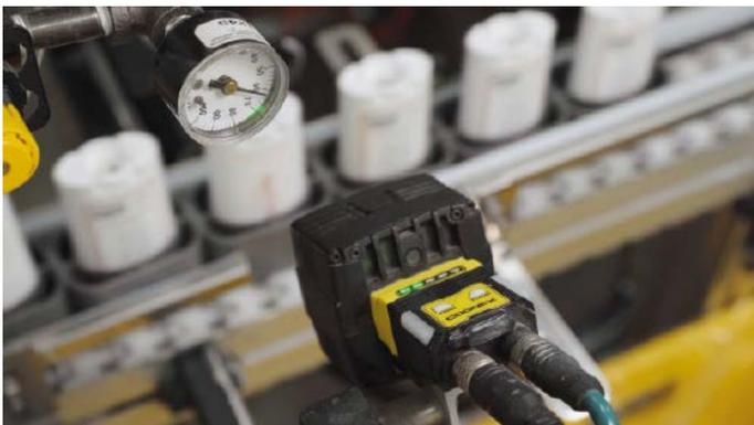
Federal Package prüft mit Hilfe der Intelligenten Kameras In-Sight 2800 von Cognex Körperpflegeprodukte nach ihrer Abfüllung auf unerwünschte Tropfspuren und die korrekte Anbringung von Etiketten.
