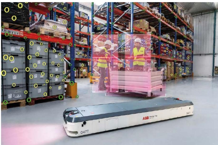
Der autonome mobile Roboter (AMR) T702 von ABB mit KI-basierter Visual-Slam-Technologie befördert Materialien und Komponenten schnell zwischen den einzelnen Stationen.
