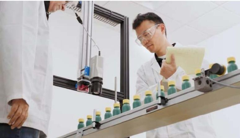
Die Verschlüsse werden durch Erhitzen einer Klebefolie versiegelt. Die gekühlte Wärmebildkamera A6301 prüft alle Verschlüsse direkt im Produktionsprozess.
