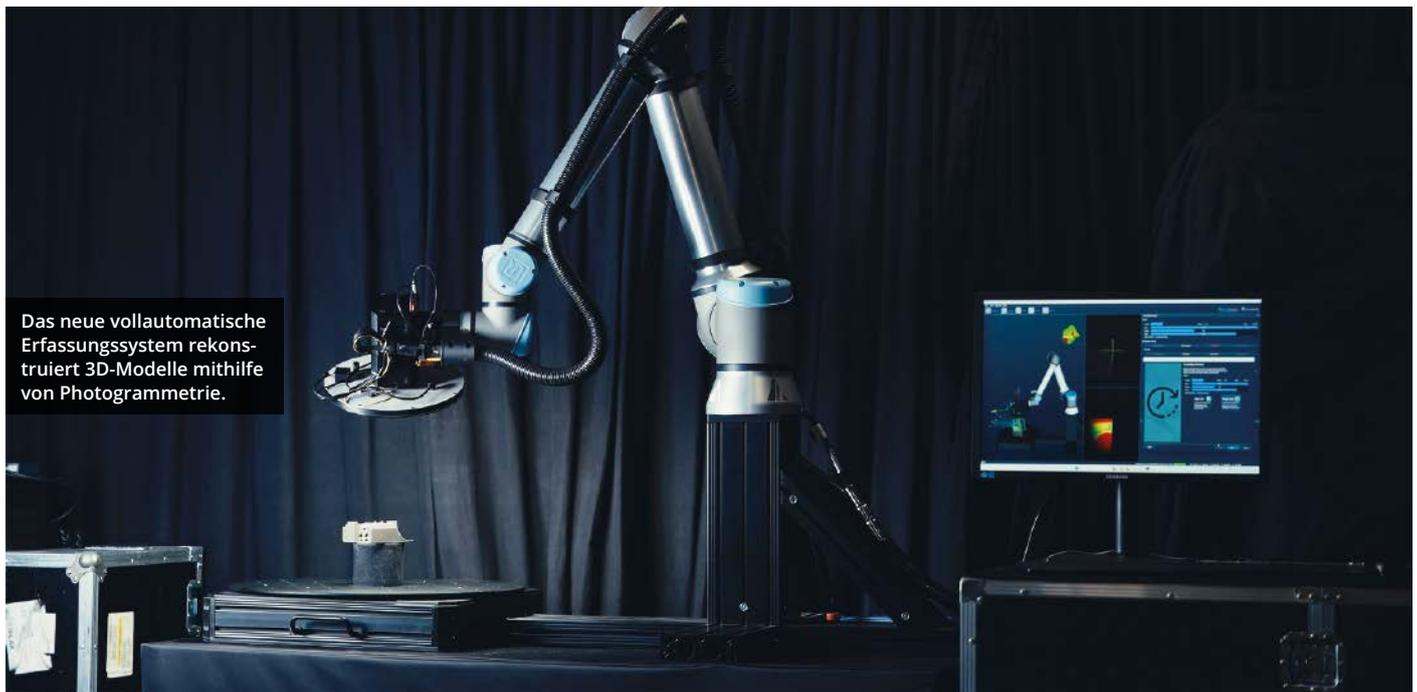
Das neue vollautomatische Erfassungssystem rekonstruiert 3D-Modelle mithilfe von Photogrammetrie.
