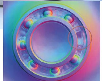
Solino digitalisiert das visuelle Erscheinungsbild von Objekten und zeigt Anomalien als Bild für die weitere digitale oder statistische Verarbeitung. Je nach Kugellagerfehler angepasster Algorithmen können die gewünschten Klassen wiederholbar dargestellt werden und sind mittels KI bewertbar.
