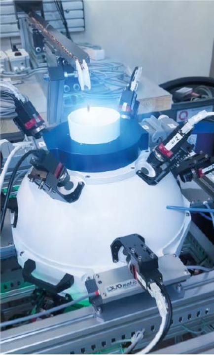
Mehrere hundert Stanzteile pro Minute werden in eine Messkugel befördert und im freien Fall von 16 Kameras erfasst. So werden Geometriefehler im Bereich von 100 Mikrometern detektiert.
