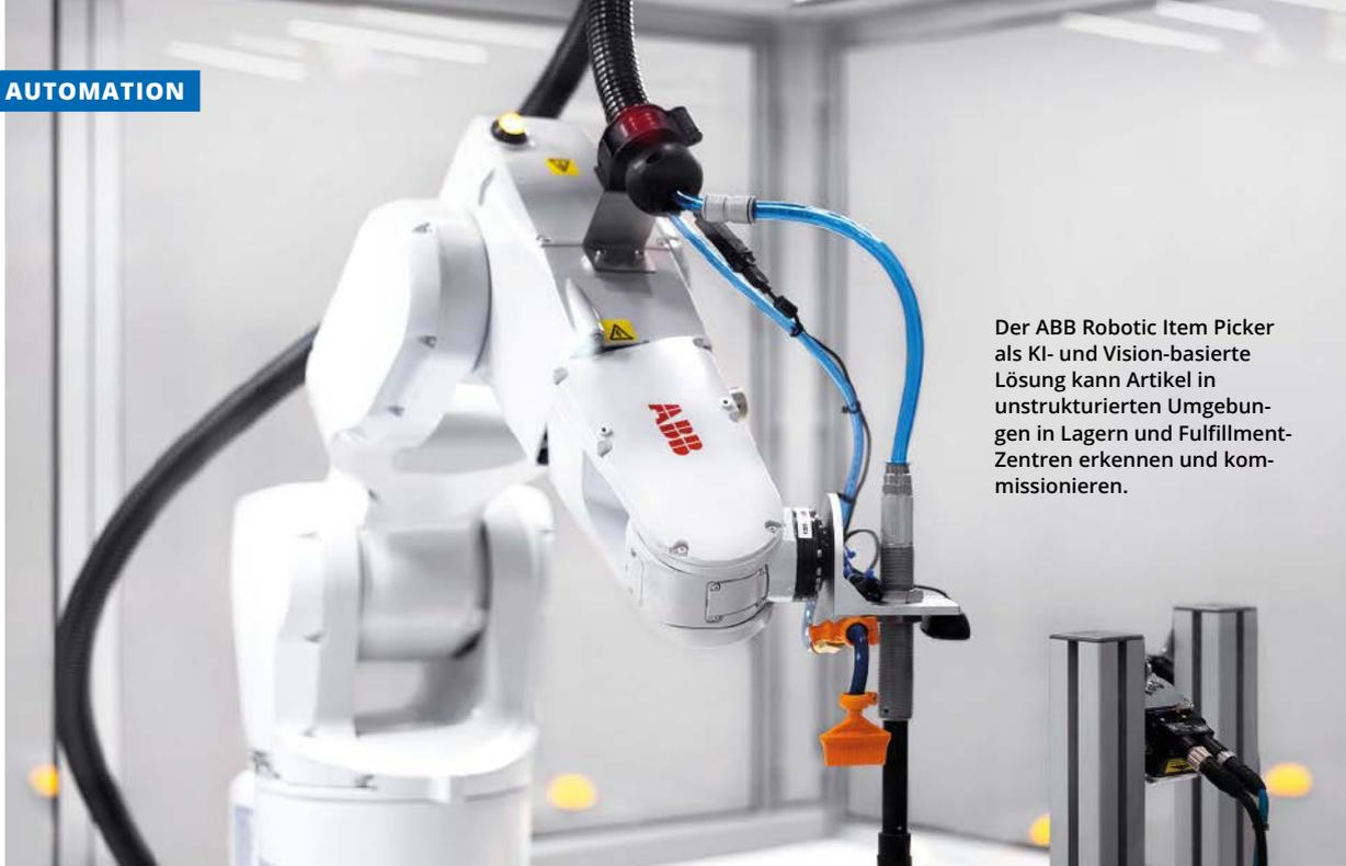
Der ABB Robotic Item Picker als KI- und Vision-basierte Lösung kann Artikel in unstrukturierten Umgebungen in Lagern und Fulfillment-Zentren erkennen und kommissionieren.
