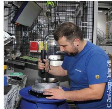
Ilias Fotiadis montiert bei Ziehl-Abegg in Kupferzell einen Axialventilator, wie sie in Rechenzentren eingesetzt werden.
