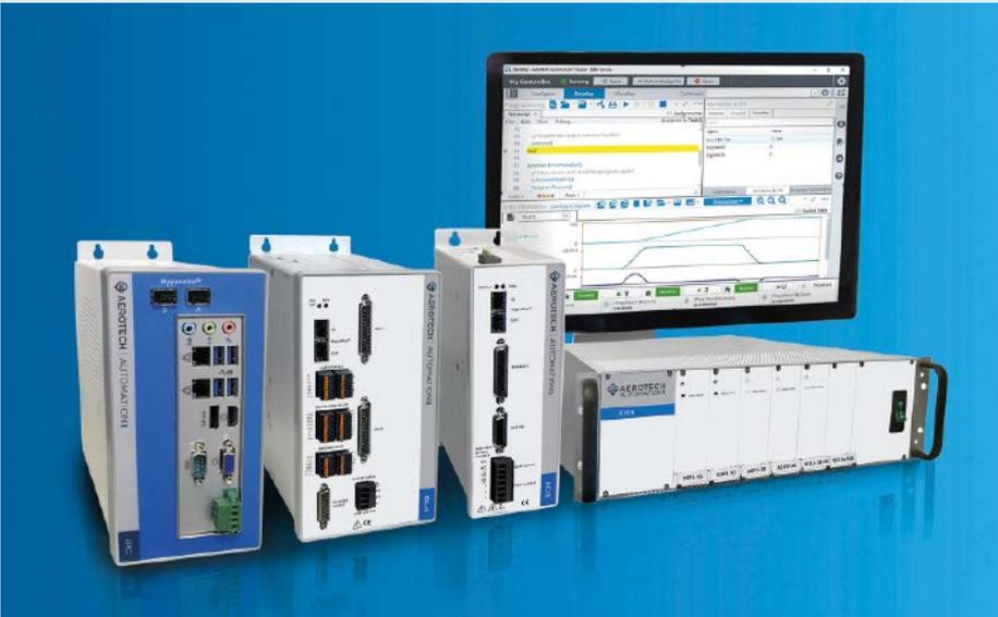
Die Steuerungsplattform Automation1 ermöglicht die direkte Ansteuerung von Servo- und Schrittmotoren, Galvo-Scan-Köpfen, piezoelektrischen Aktoren und verschiedenen anderen Geräten. Verbunden sind die einzelnen Achsen über den HyperWire-Bus.
