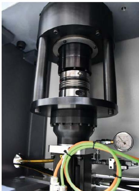
Das Neco-Getriebe ist im Sockel der Prüfmaschine untergebracht. Aufgrund der hohen Präzision und Leistungsdichte ist das Regeln von kleinen Proben-
