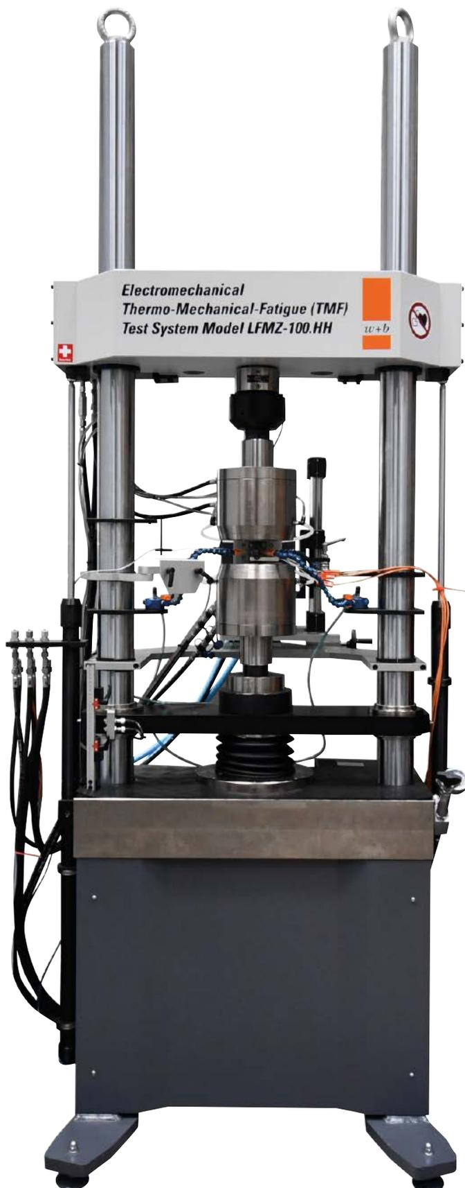
Materialprüfmaschinen müssen absolut sichere und reproduzierbare Messergebnisse liefern. Deshalb nutzt ein Hersteller bei seinen elektromechanischen Zentralspindel-Prüfmaschinen nur Präzisionsgetriebe. Die kompakt gebauten Getriebesysteme in zyklorder Bauart sorgen hierbei für einen spielfreien Antriebsstrang.
