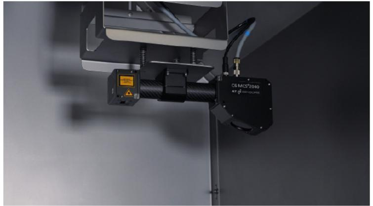
Der MCS 2040 erfasst 2.048 Messpunkte pro Profil und erreicht eine Auflösung von 0,5 Millimetern in der X-Achse und 0,03 Millimetern in der Z-Achse. Ein Sichtfeld von 1 Meter und eine Profilgeschwindigkeit von bis zu 25 Kilohertz gewährleisten eine schnelle und kontinuierliche Datenerfassung auch bei sehr hohen Durchsatzraten.
