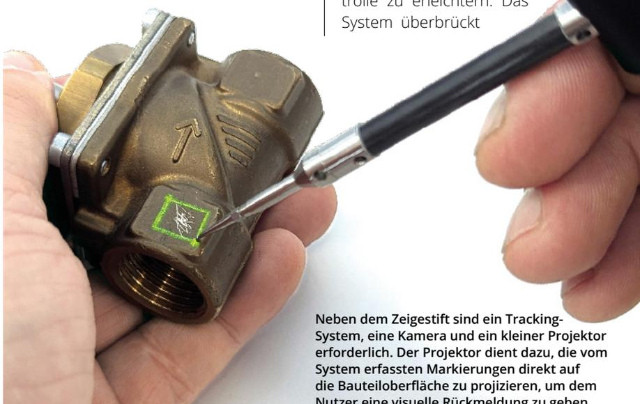
Neben dem Zeigestift sind ein Tracking-System, eine Kamera und ein kleiner Projektor erforderlich. Der Projektor dient dazu, die vom System erfassten Markierungen direkt auf die Bauteiloberfläche zu projizieren, um dem Nutzer eine visuelle Rückmeldung zu geben.
