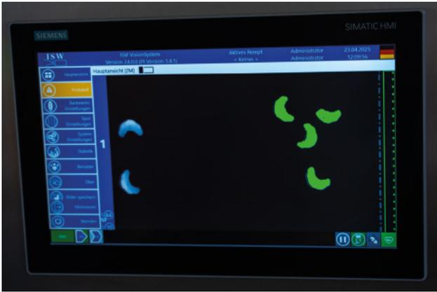
Die erfassten 3D-Daten werden mit der von ISW entwickelten Software verarbeitet, die auf der Bildverarbeitungsbibliothek Halcon basiert. Die verarbeiteten Informationen werden direkt an die speicherprogrammierbare Steuerung (SPS) weitergeleitet, wo sie die Sortiermechanismen des Verpackungssystems steuern.
