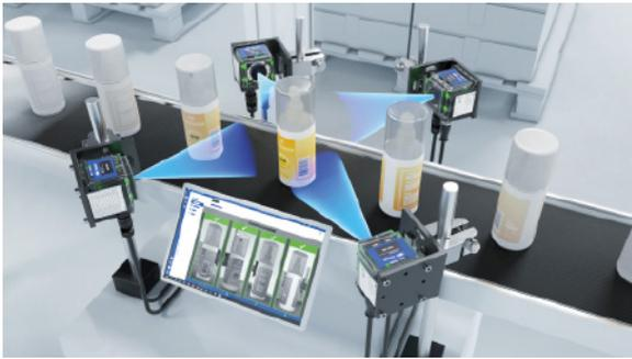
Die Kameras der neuartigen Baumer IXG-Serie eignen sich für eine Vielzahl an Mainstream-Anwendungen. Wenige Komponenten und eine einfache Verkabelung ermöglichen selbst Mehrkamera-Anordnungen.
