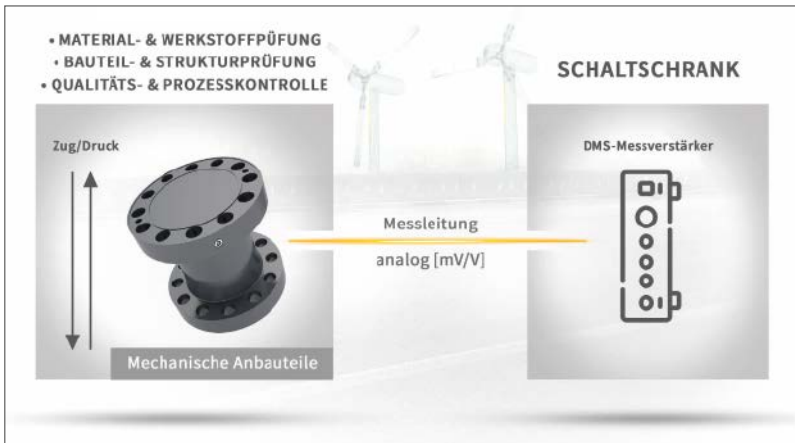
Aufbau einer klassischen Kraftmesskette
