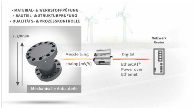
Aufbau einer dezentralen Kraftmesskette
