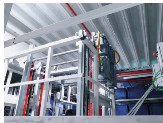
Synchron-Servomotoren CMP112 M mit Kegelradgetrieben KA77B von SEW-Eurodrive bewegen über die roten Zahnriemen die Shuttle-Aufzüge.
