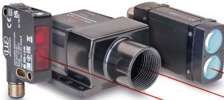
Laser-Distanzsensoren der Baureihe optoNCDT ILR104x messen Abstände bis 10 m ohne Reflektorfolie (ILR1040) und bis zu 60 m (ILR1041) mit Reflektorfolie bei einer einstellbaren Messrate von bis zu 333 Hz.
