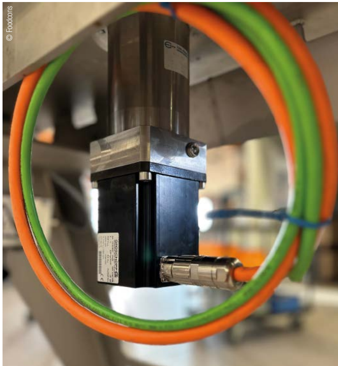
Positioniergenauigkeit, Dynamik und Leistungsdichte sind die Vorteile des eingesetzten Servomotors.
